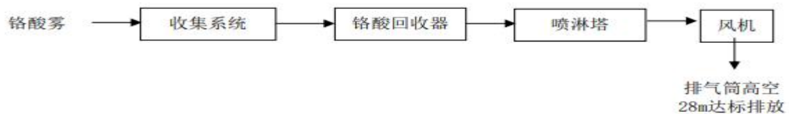
图 6-3 铬酸雾废气处理工艺流程图
